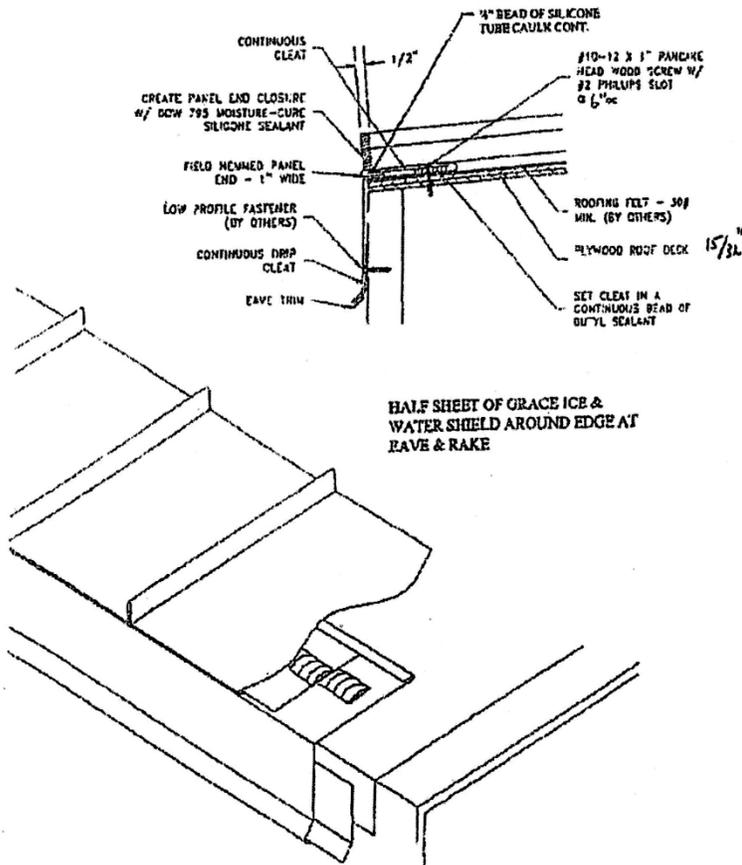
HALF SHEET OF GRACE ICE & WATER SHIELD AROUND EDGE AT EAVE & RAKE
